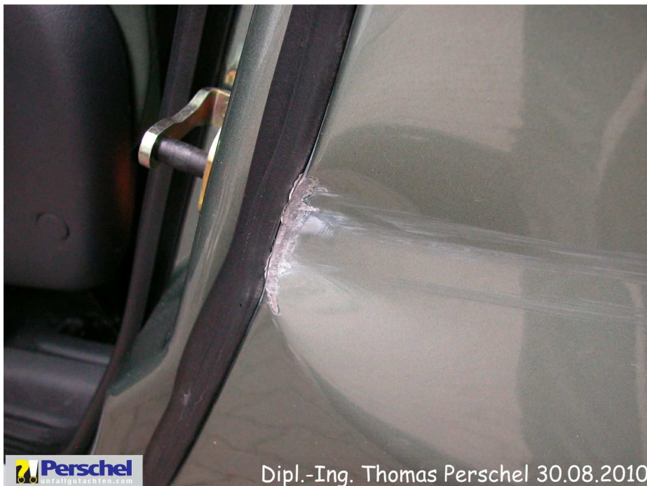
Bild 8: Kante Seitenwand h I durchgeschliffen
