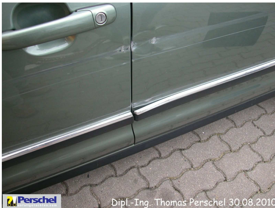
Bild 6: Türen l streifend beschädigt
