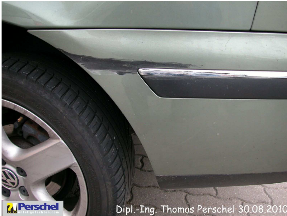
Bild 9: Stoßfänger h | streifend beschädigt
