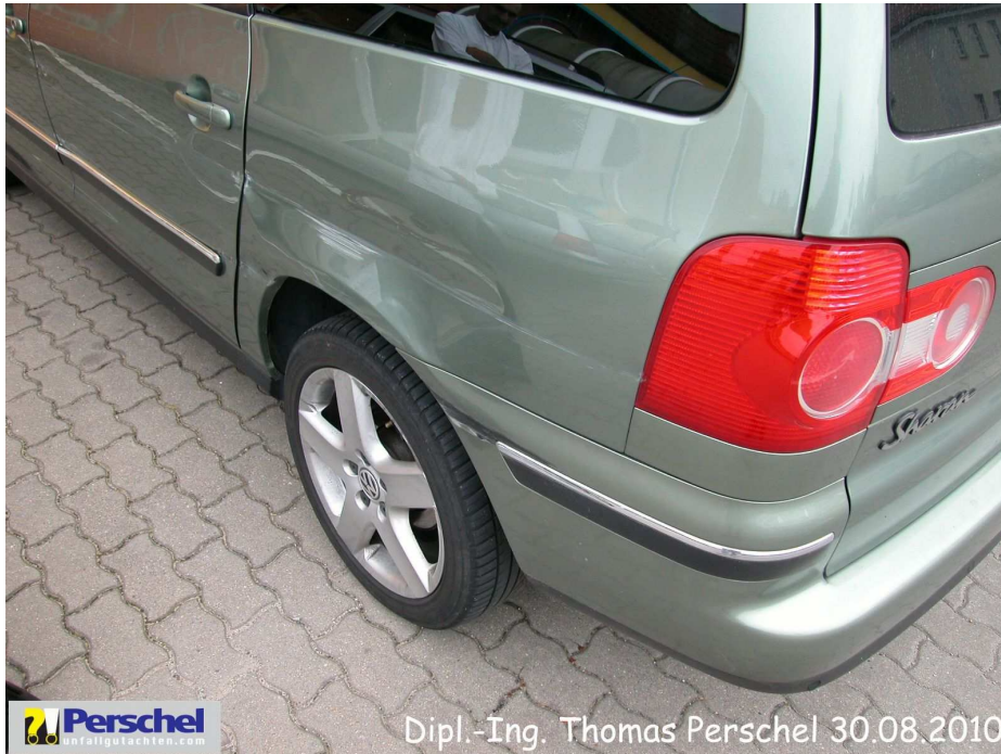
Bild 7: Seitenwand h I großflächig streifend eingedrückt
