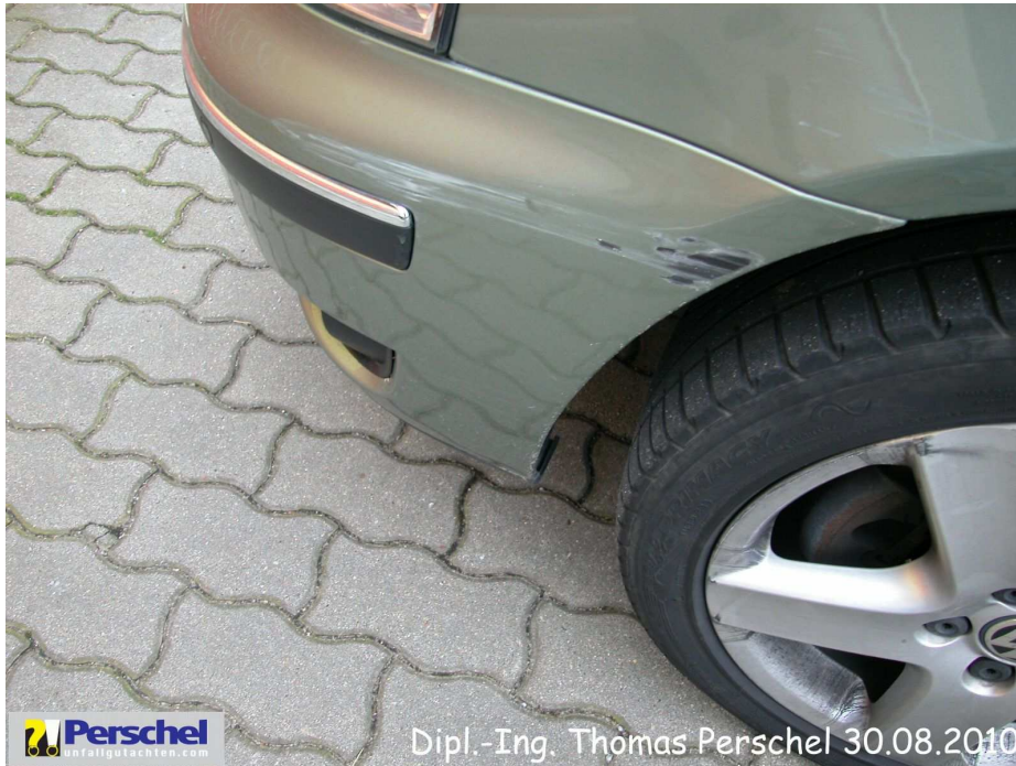
Bild 3: Stoßfänger v l streifend beschädigt
