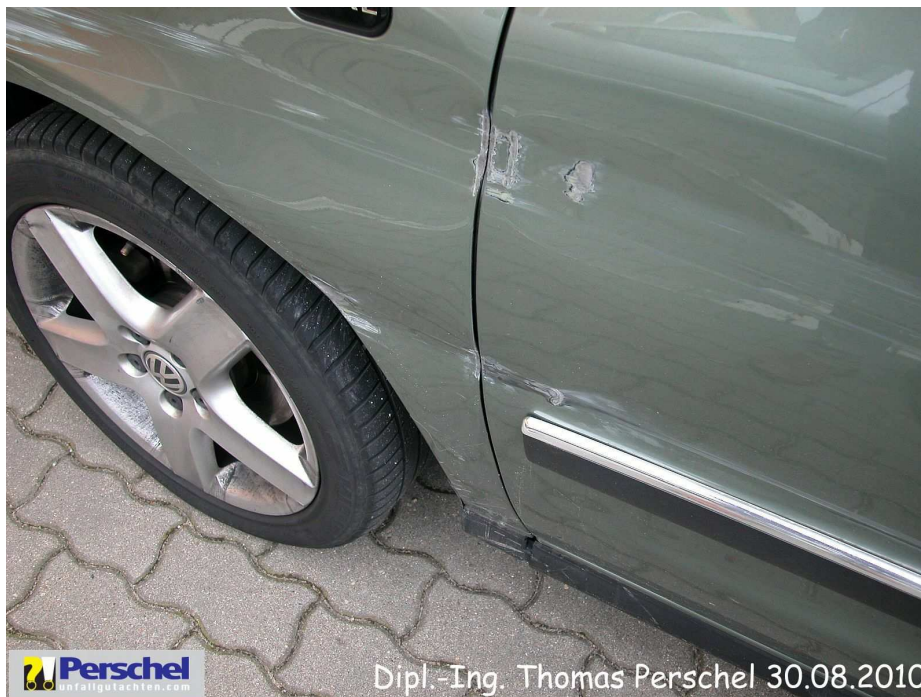
Bild 5: Kotflügel v l und Tür v l streifend beschädigt
