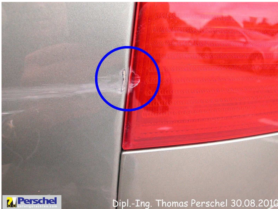
Bild 10: Rückleuchte | streifend beschädigt
