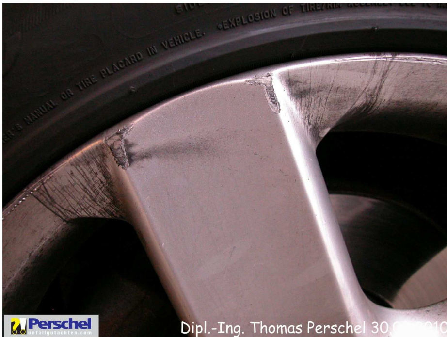
Bild 4: Felge v l beschädigt
