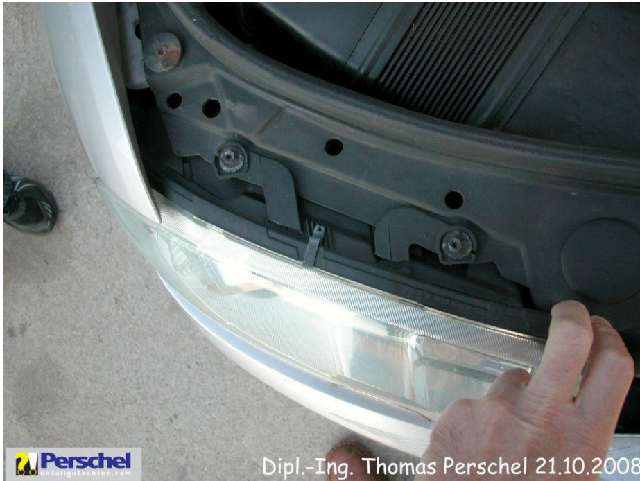
Bild 11: Scheinwerfer r gerissen
