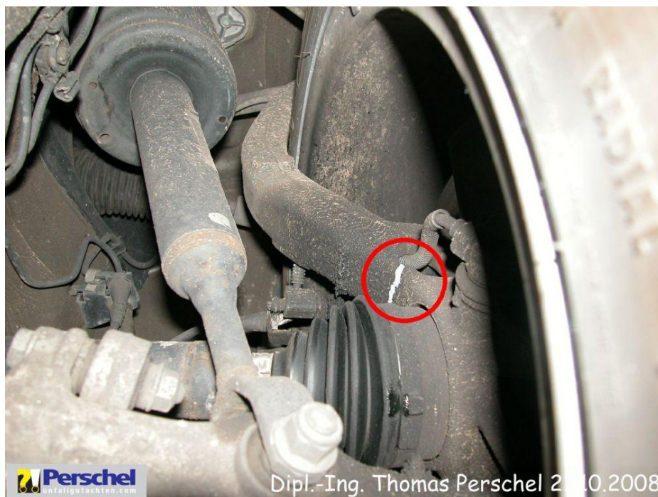
Bild 8: Radlagergehäuse deformiert, Reifen schleift von innen
