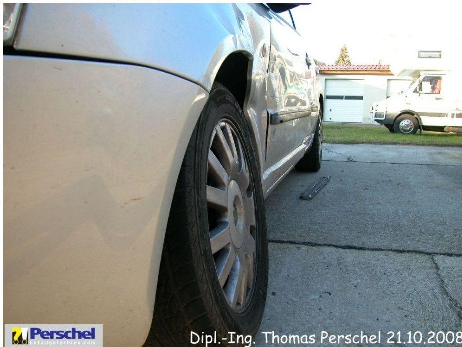
Bild 7: sichtbar stark negativer Radsturz → Achsteile v l deformiert
