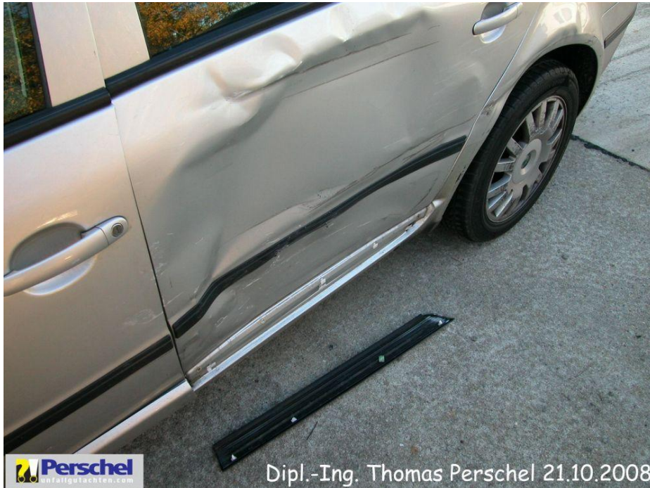
Bild 5: Tür h l großflächig eingedrückt
