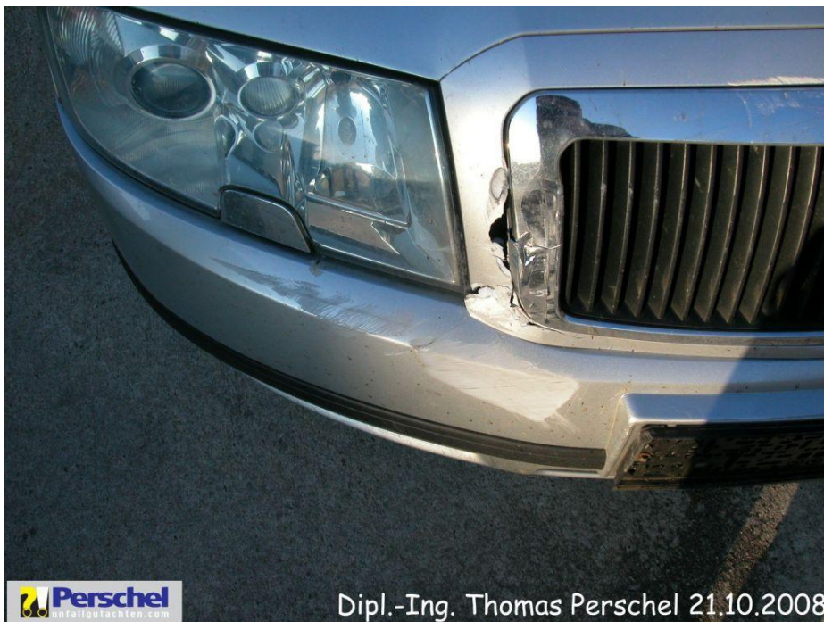
Bild 10: Grill gerissen, Verkleidung Stoßfänger beschädigt und deformiert
