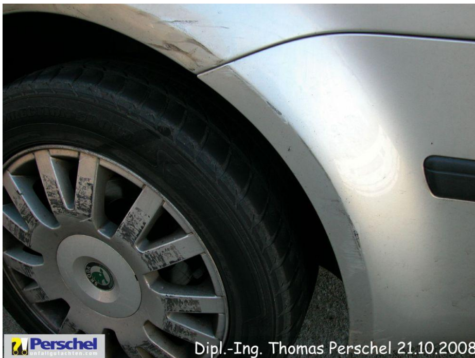
Bild 4: Lackierung Stoßfänger h I beschädigt
