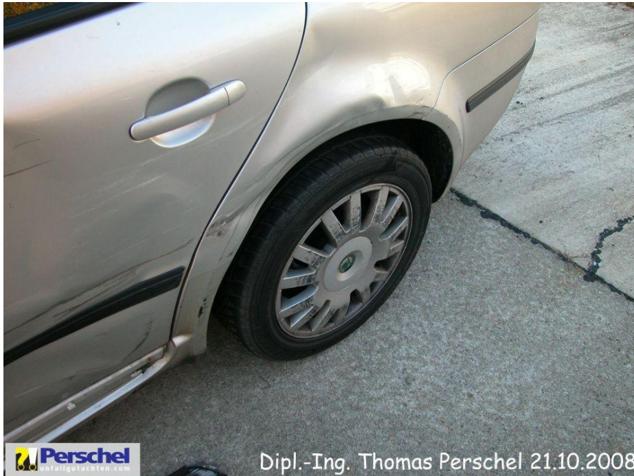
Bild 3: Seitenwand h I, Radkasten h I eingedrückt
