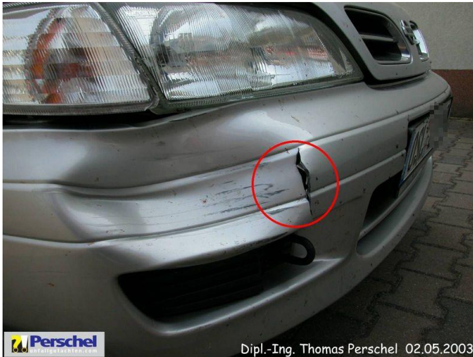
Bild 3: Stoßfänger v eingedrückt und gerissen
