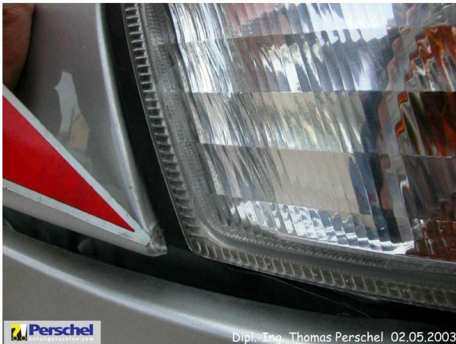
Bild 4: Lackierung Kotflügel abgeplatzt
