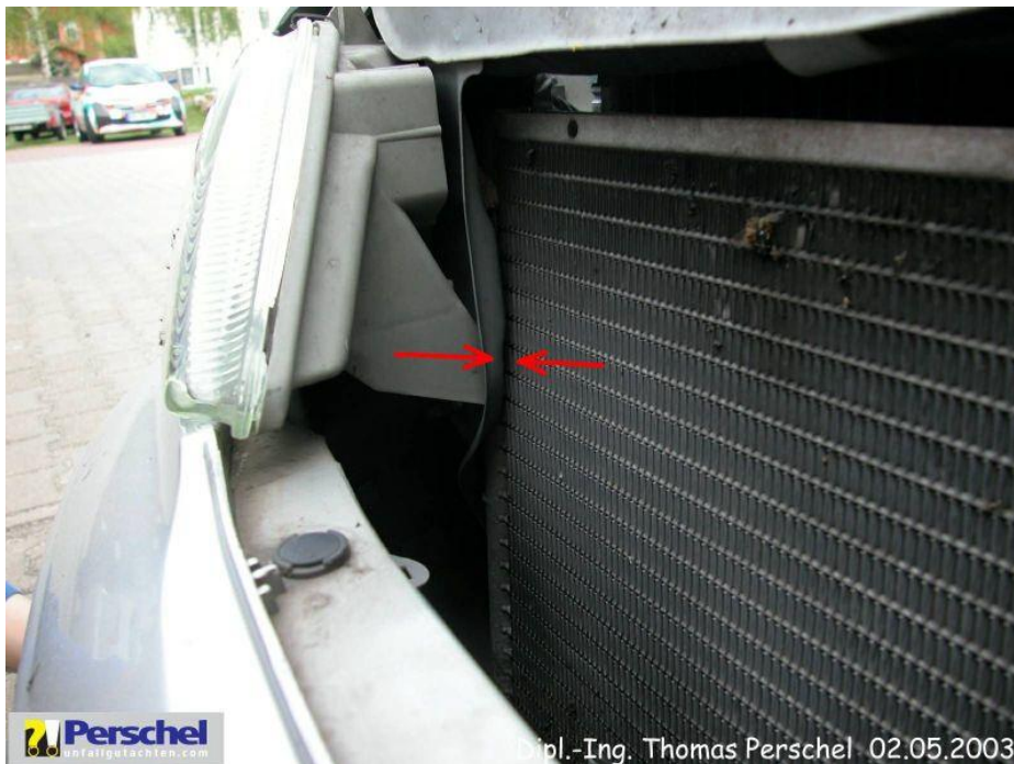
Bild 6: Maskenblech Scheinwerfer r eingedrückt
