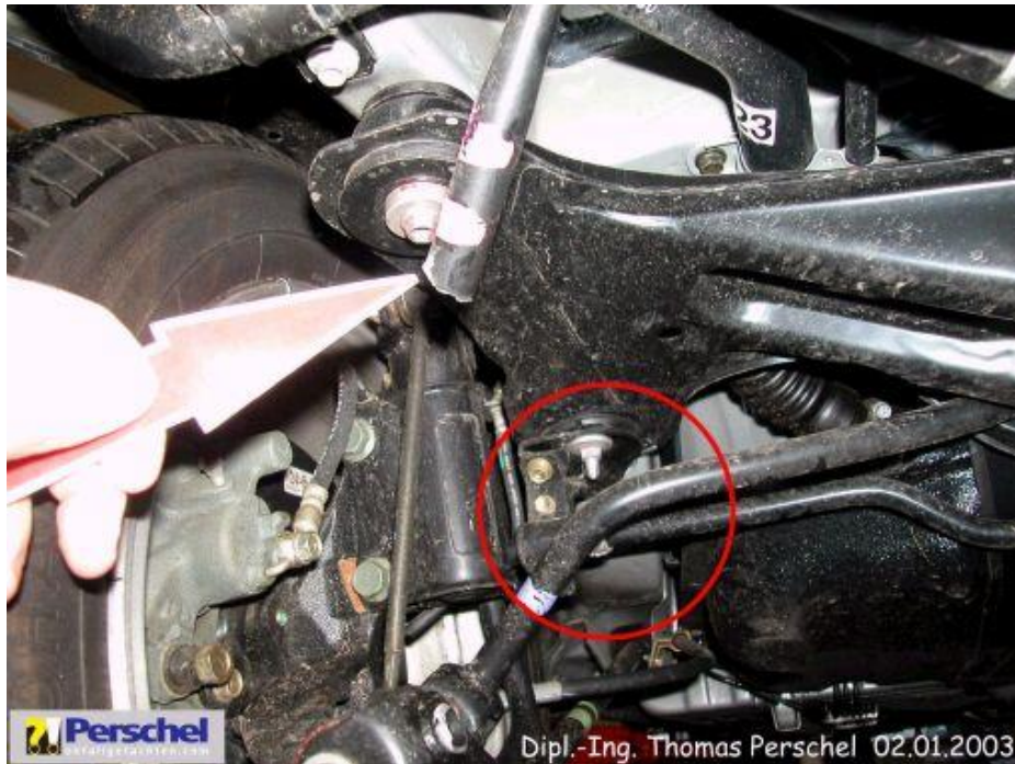
Bild 7: Führungstange h I gerissen bzw. stark gestaucht
