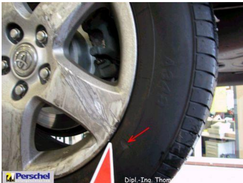
Bild 6: Reifen h l, Felge h l beschädigt
