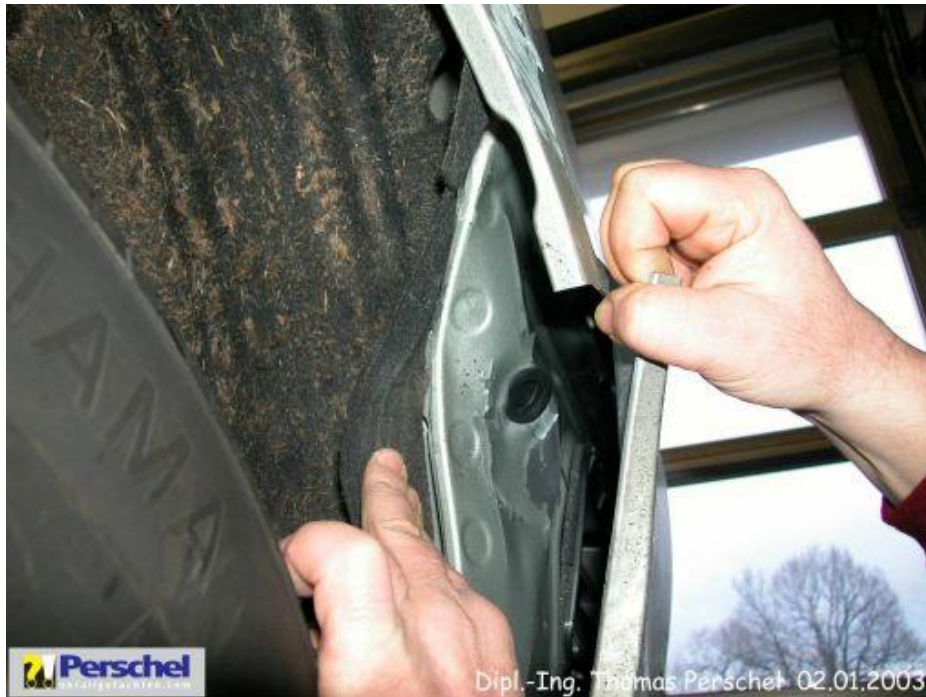
Bild 5: Seitenwand h l u, Luftgitter l beschädigt
