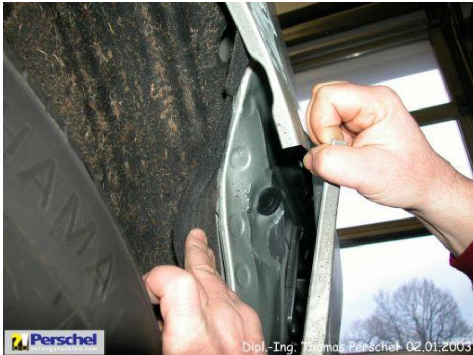
Bild 5: Seitenwand h I u, Luftgitter I beschädigt
