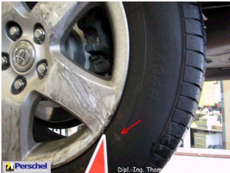
Bild 6: Reifen h I, Felge h I beschädigt
