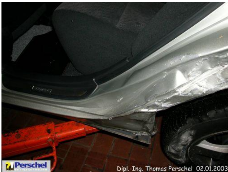
Bild 4: Kniestück Seitenwand, Schweller I im Anschlussbereich, Radkasten I a beschädigt
